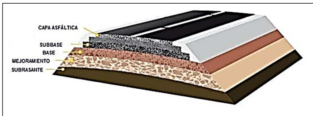
Gráfico. N° 19.- Sección Transversal típica de un Pavimento.
