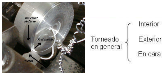
Figura 14. Mecanizado de Torneado
