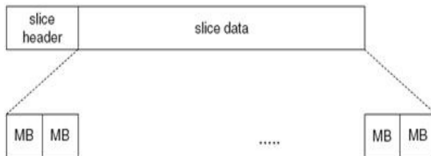
Figura 6. 4 Estructura de una franja
