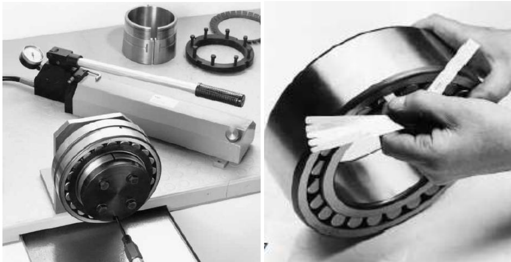
Figura No10: Sistema hidráulico de Montaje de Rodamientos de Rodillos Cilíndricos para eje cónico y Ajuste de Juego Radial Interno
