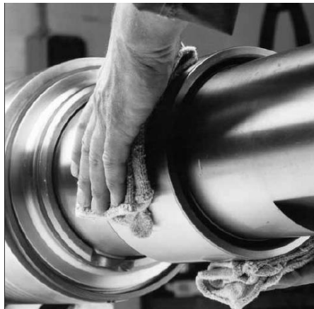
Figura No7: Limpieza de eje a montar rodamiento
