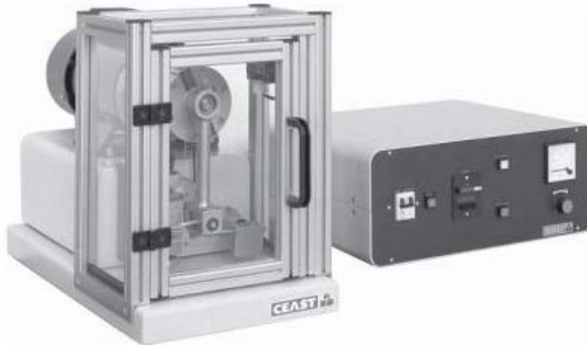
Figura 6-1 Máquina para ensayo a fatiga de polímeros
