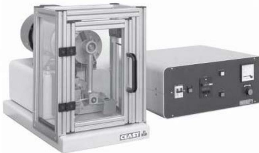
Figura 2-15 Máquina para ensayo a fatiga de polímeros
