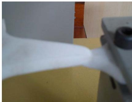
Figura 9-3 Probeta deformada
