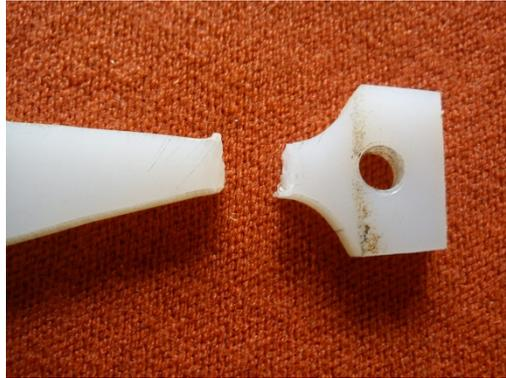
Figura 5-1 Tipo de falla en probeta de Nylon
