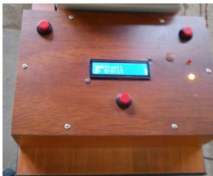
Figura 6-9 Circuito electrónico para contar el número de vueltas
