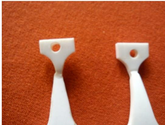
Figura 5-2 Tipo de falla en probeta de Teflón
