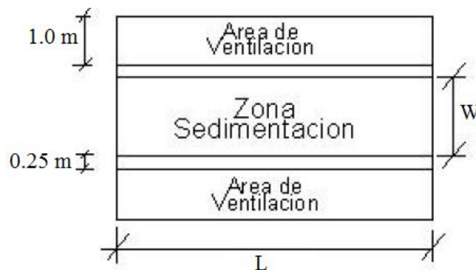
Gráfico N° 4. Dimensión del tanque Imhoff.
