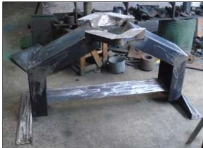
Figura 2.4 Bancada máquina canteadora de madera ensamblada
