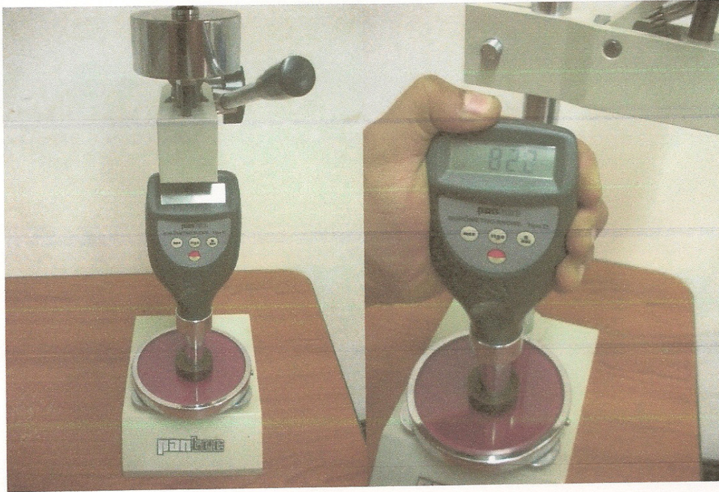
Figura 1. Medición de dureza Shore D en probeta de material polimérico.
