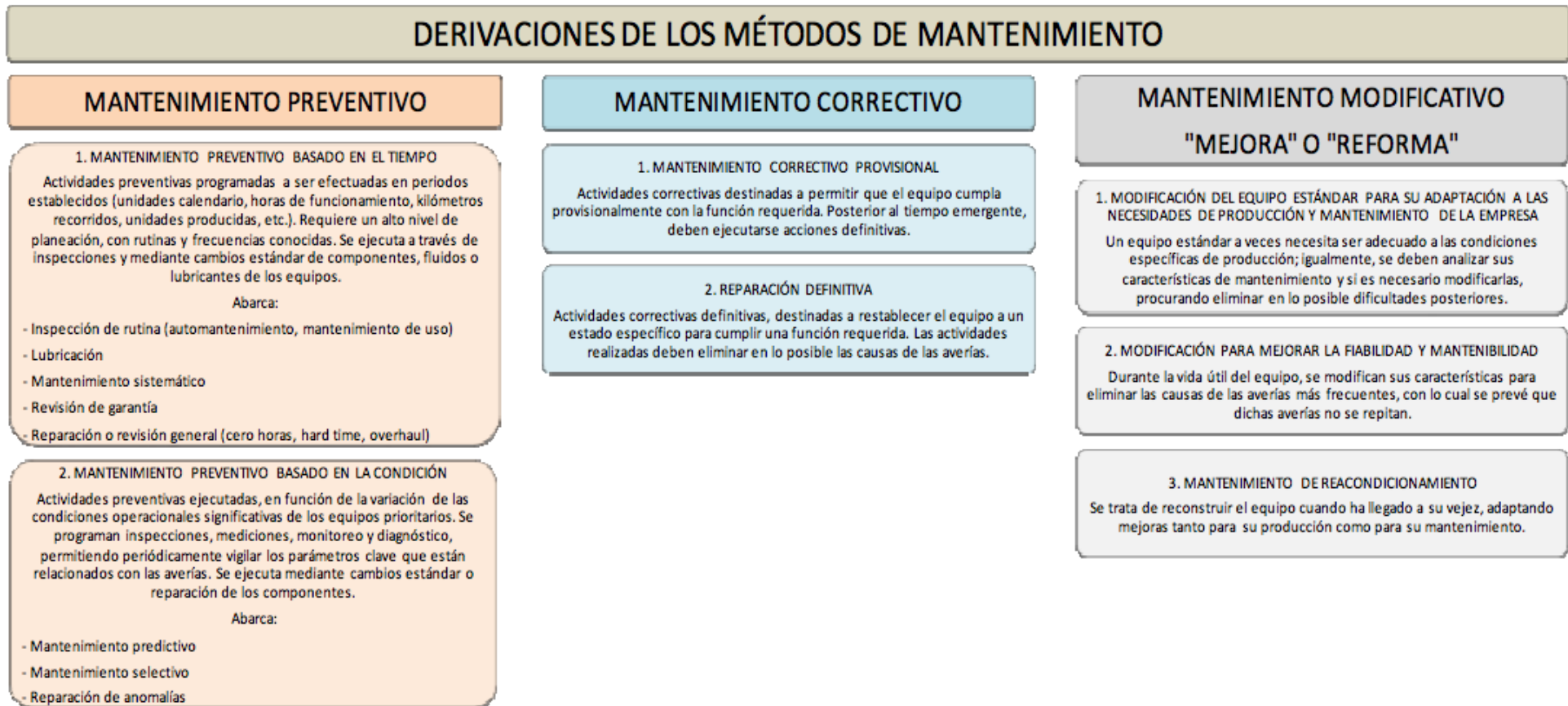
Figura 2.15: Derivaciones de los métodos de mantenimiento.
