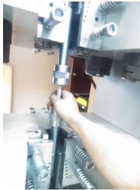
Figura6.16.- probeta acoplada a la maquina universal
