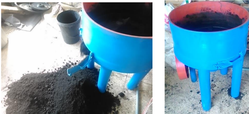
Anexo A1.2.-Mezcla de arena agua en la maquina
