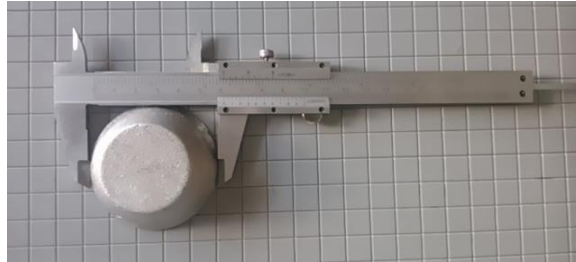
Figura6.30.- Medición lineal de la pieza fundida
