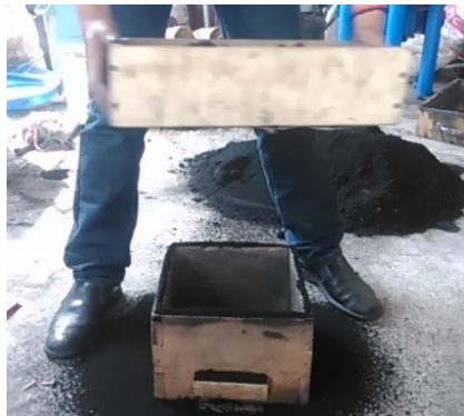
Figura6.6.- Colocación de la arena fina sobre el modelo
