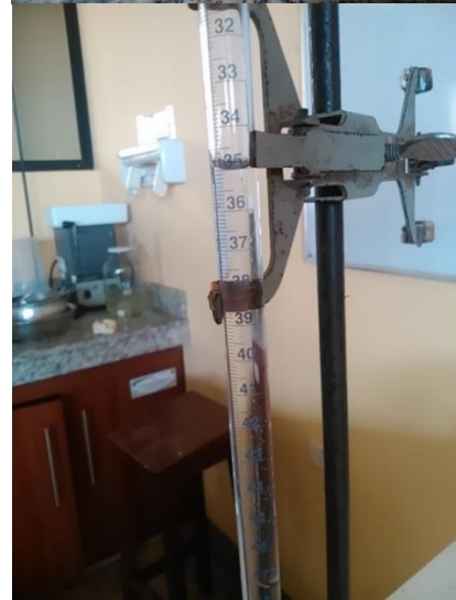
Figura6.31.- Medición de contracción volumétrica de la pieza fundida
