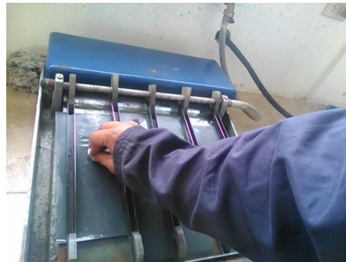
Figura 6.21.- Pulido de la probeta
