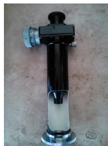
Figura 6.27.- Microscopio manual y huella dejada por el durómetro
