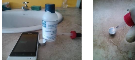
Figura6.22.- Ataque químico de la superficie de la probeta
