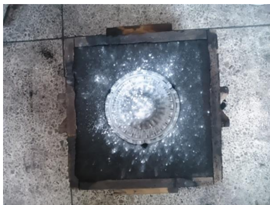
Figura6.19.- Montaje de la segunda caja y bebederos
