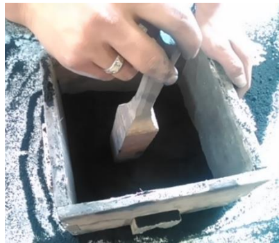
Figura6.7.- Apisonamiento de la arena fina sobre el modelo
