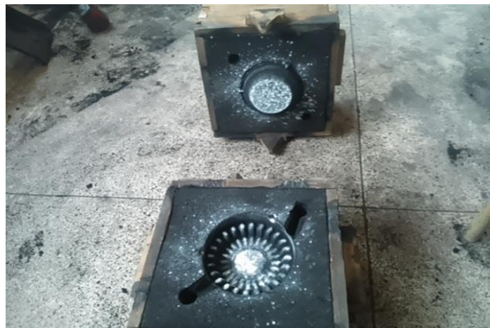
Anexo A1.6.-Molde realizado en arena
