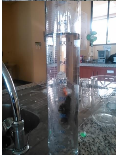
Figura6.31.- Medición de contracción volumétrica de la pieza fundida
