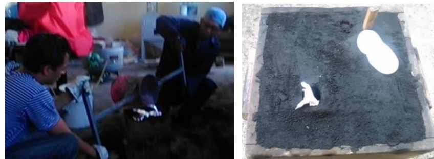
Figura 6.12.- Proceso de colocación del aluminio en molde por el bebedero
