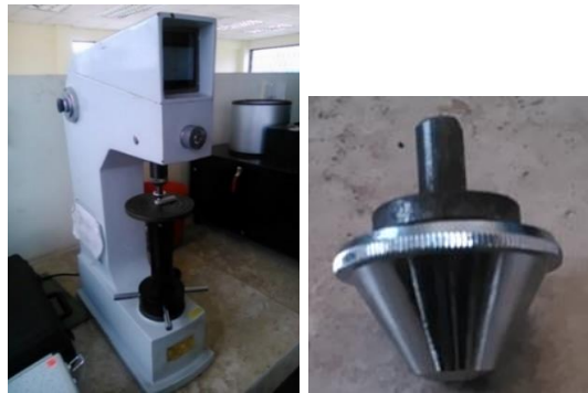
Figura 6.26.- Durómetro e indentador
