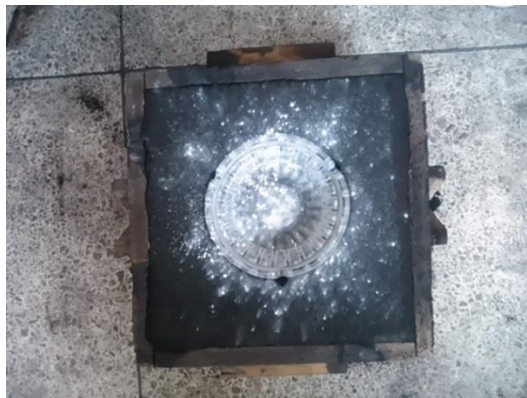
Figura6.8.- Montaje de la segunda caja y bebederos
