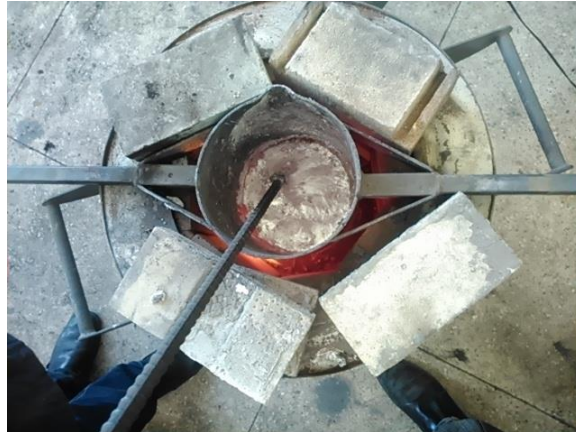
Figura 6.11.- Limpieza de las impurezas de la colada de aluminio
