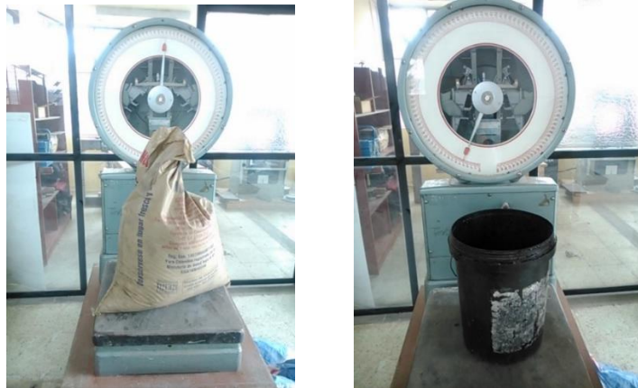
Figura6.3.-Pesaje de la arena y el agua
