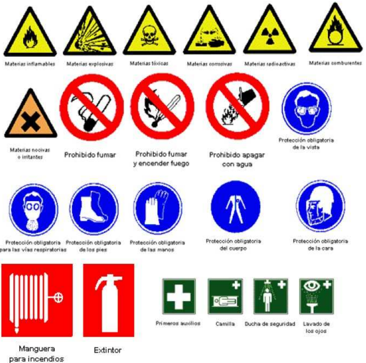
Figura N° 9: Señalización de seguridad relacionada con los riesgos por agentes químicos.
