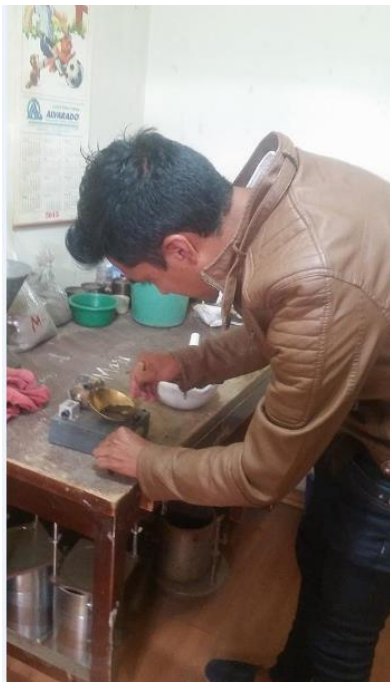
Foto 29.- División del suelo con el ranurador
