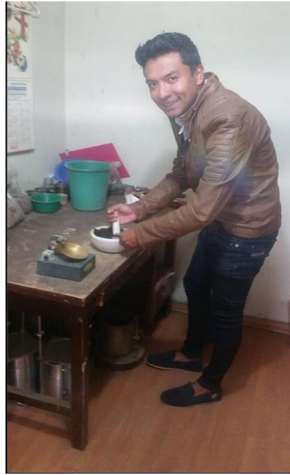
Foto 28.- Mezcla del suelo + porcentaie de agua determinado
