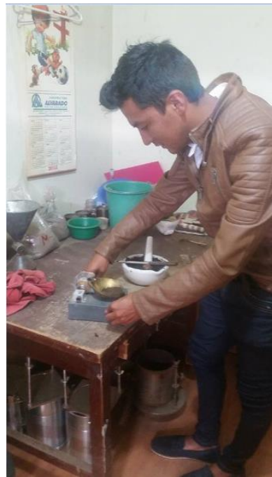
Foto 30.- Determinación del límite líquido
