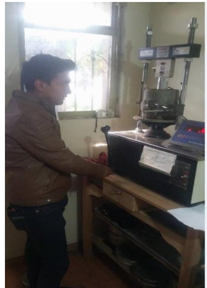
Foto 26.- Ensayo de CBR
