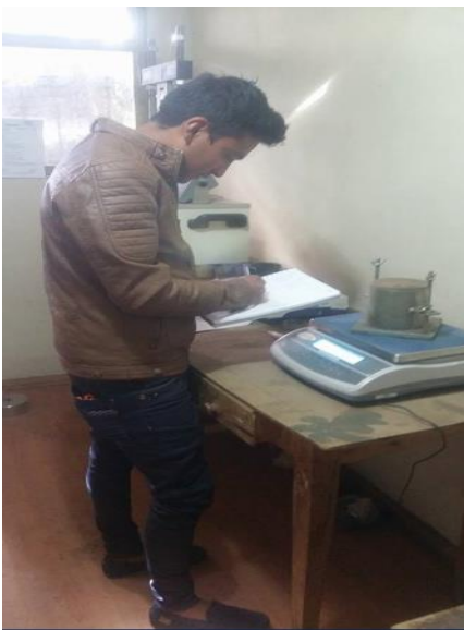
Foto 25.- Pesando el molde + suelo humedo
