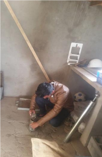
Foto 23.- Colocación del suelo en el molde
