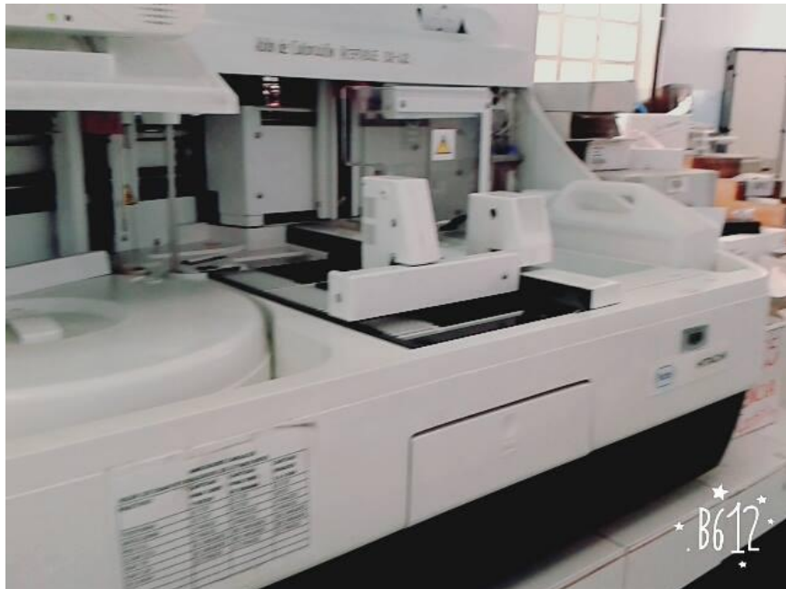
Imagen N.- 10 Equipo Cobas E311 para procesar las muestras:
