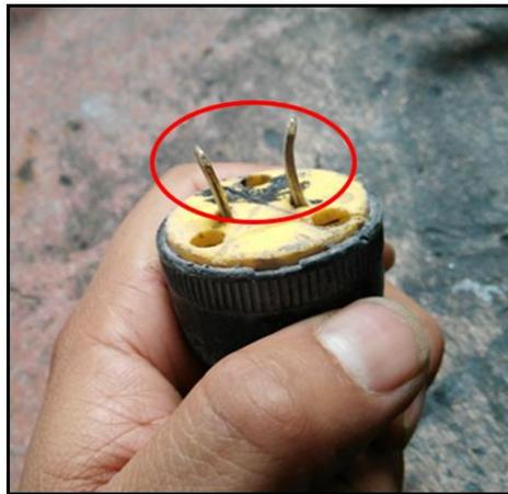
*Figura 4. 5* Patas de contactos dobladas.
