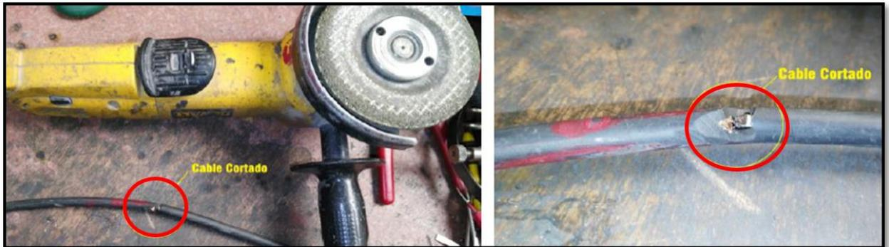
*Figura 4. 6* Cable de alimentación cortado.
