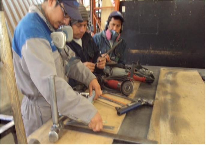
ANEXO D. Inspección del uso de guardas de seguridad y mangos en amoladoras.
