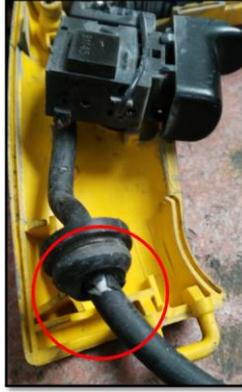
*Figura 4. 8* Avería de la entrada del cable de alimentación.
