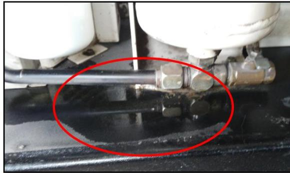
*Figura 4. 4* Residuo representativo de aceite hidráulico en el compresor de tornillo.
