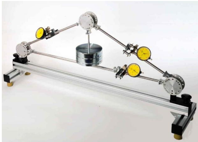
Figura 2.7: Equipo para la determinación de esfuerzos en celosías simples
