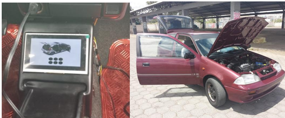
Figura 4.59 Reacción del Ordenador Vehicular ante una puerta o compartimiento abierto del automóvil
