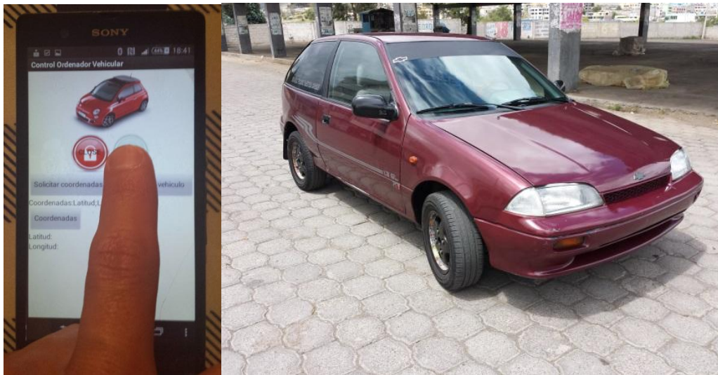
Figura 4.61 Activación del Sistema de bloqueo de acceso al vehículo
