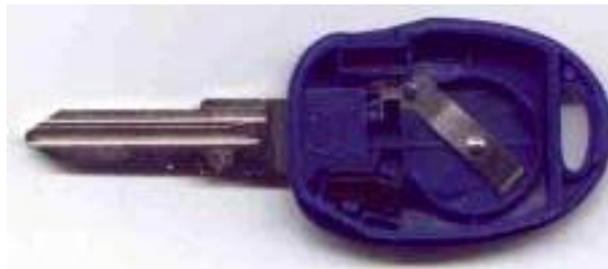
Figura 2.9 Llave con un chip insertado en el mango Fuente: Manual Técnico, Inmovilizadores. [12]
