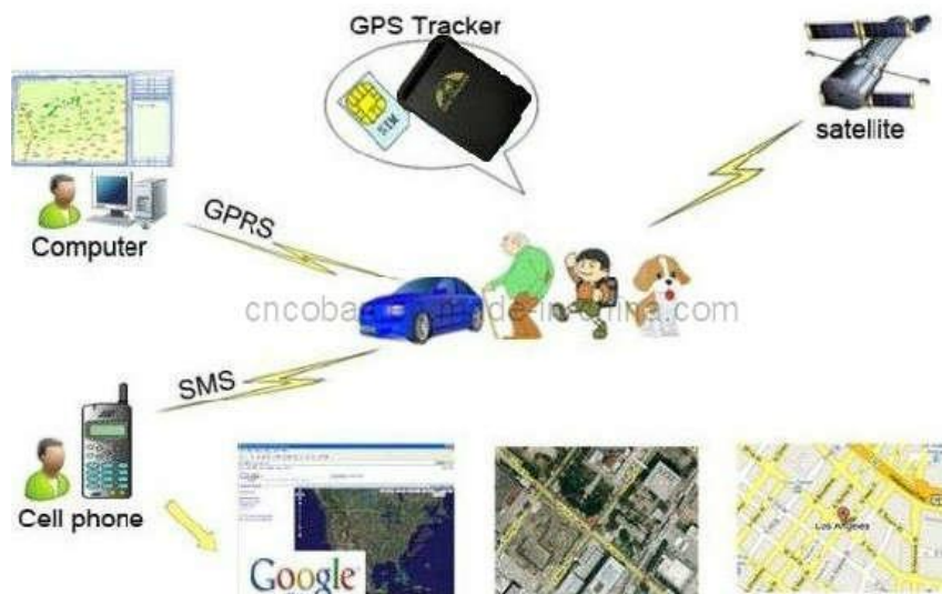
Figura 4.4 Diagrama de comunicación TRACKER GPS
