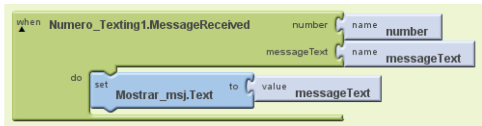
Figura 4.44 Comportamiento del Componente MessageReceived Fuente: El Investigador
