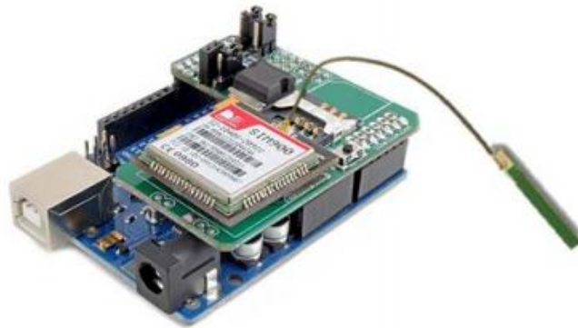
Figura 4.16 Plataforma Arduino Uno + Shield Sim908 GSM/GPRS/GPS. Fuente: El Investigador.
