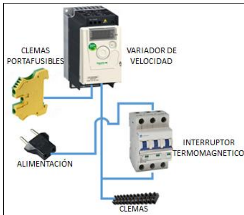
Figura 60: Representación esquemática del variador con sus dispositivos
