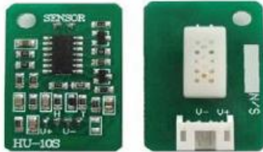
Figura 6.2. Módulo Sensor de Humedad y Temperatura
