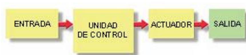
Figura 2.1. Elementos de un sistema automático lazo abierto
