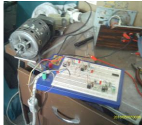
Figura 6.11. Comprobación de funcionamiento de motorreductor
