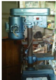
Figura 6.10. Pintado de partes de taladro de pedestal
