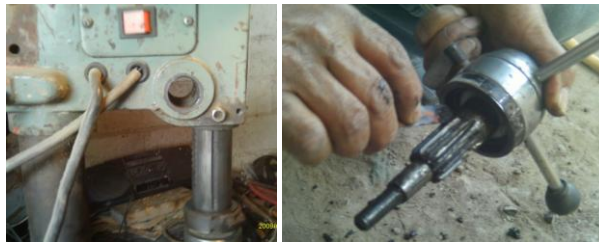
Figura 6.7. Limpieza piñón y cremallera de taladro de pedestal.
