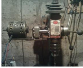
Figura 6.8. Acoplamiento de motorreductor a cabezal de taladro
