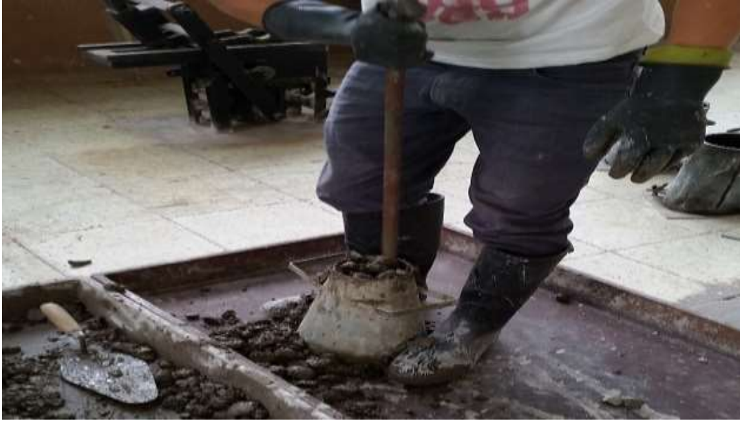
Fotografía N° 10.- Colocación de la muestra en el Cono de Abrams
