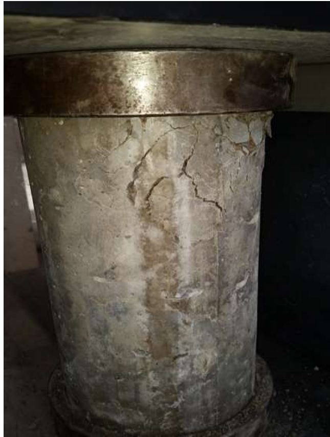
Fotografía N° 14.- Probeta con fibra de coco ensayada
