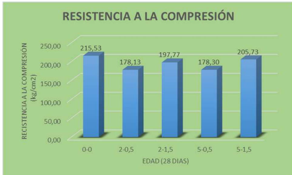
Gráfico N° 10.- Resistencia a compresión del hormigón a los 28 días de edad con diferentes longitudes y porcentajes de fibra de coco, f'c = 210 \text{ kg/cm}^2 , según la tabla # 33.
