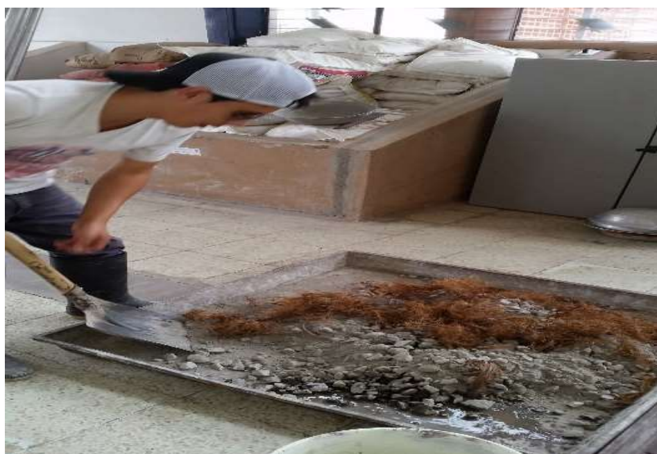
Fotografía N° 7.- Mezcla de materiales con la con la incorporación de La fibra
