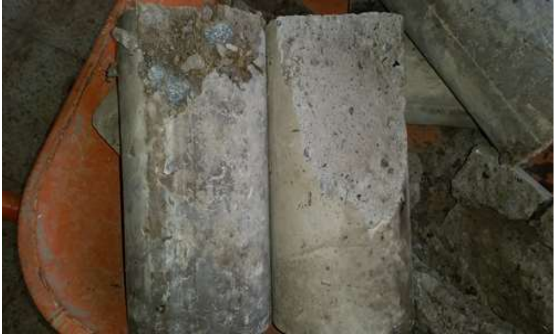
Fotografía N° 16.- Muestras ensayadas de hormigón con fibra de coco vs. Hormigón convencional
