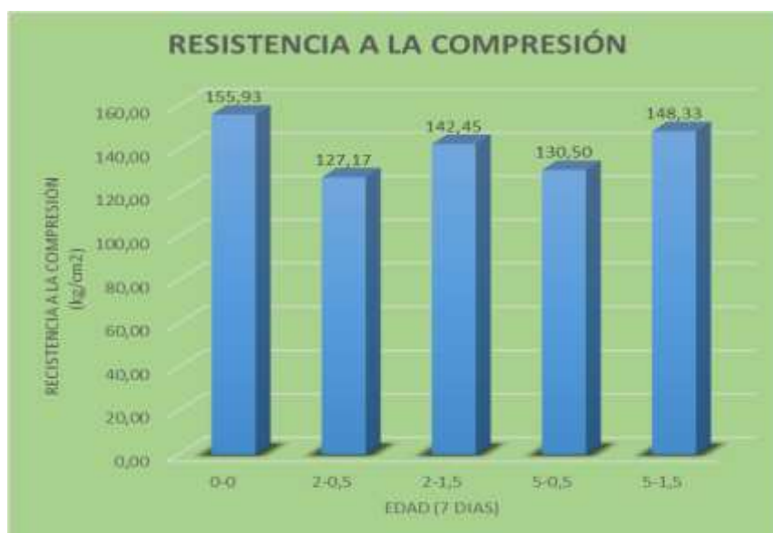
Gráfico N° 7.- Resistencia a compresión del hormigón a los 7 días de edad con diferentes longitudes y porcentajes de fibra de coco, f'c = 210 \text{ kg/cm}^2 , según la tabla # 30.
