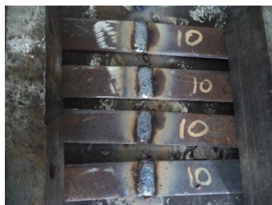
Figura 4. 8 Soldadura de probetas
