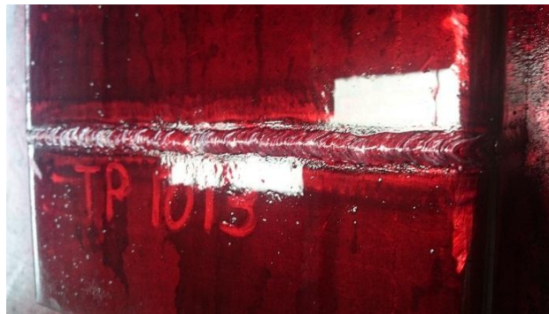
Figura 4. 29 Aplicación del penetrante en la soldadura
