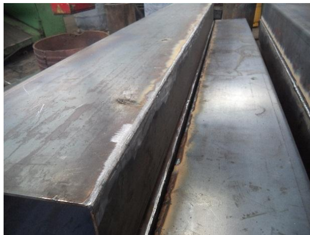
Figura 4. 21 Soldado laterales columna
