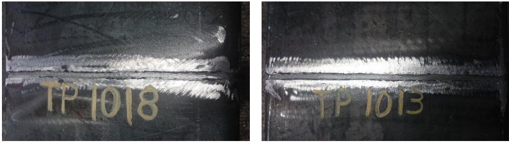
Figura 4. 25 Limpieza de soldadura de penetración
