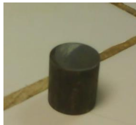
Gráfico Nº 95. Probeta de Acero AISI 1045 sin Modificación Elaborado por: Carlos Calderón
