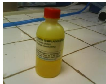
Gráfico Nº 107. Ataque químico del Acero AISI 1045 revenido Fuente: lab. Metalografía UTA-FICM Elaborado por: Carlos Calderón
