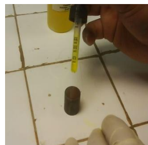
Gráfico Nº 107. Ataque químico del Acero AISI 1045 revenido Fuente: lab. Metalografía UTA-FICM Elaborado por: Carlos Calderón
