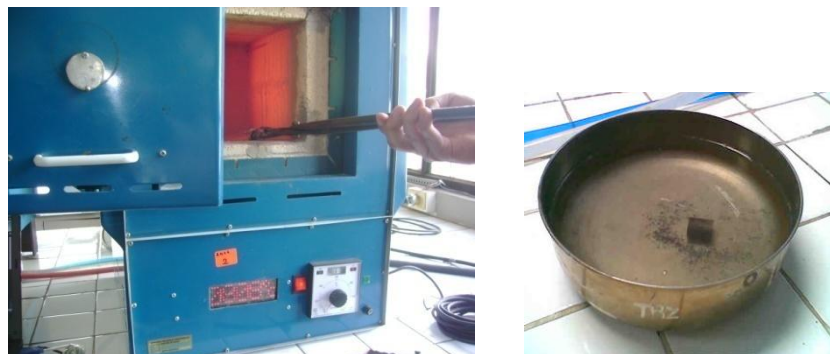
Gráfico Nº 100. Proceso de temple del Acero AISI 1045 Fuente: lab. Metalografía UTA-FICM Realizado por: Carlos Calderón
