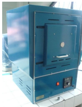
Graf. 34. Horno Eléctrico de Resistencias del Lab. Materiales UTA Fuente: Carlos Calderón
