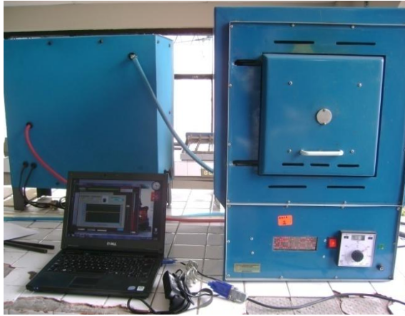
Gráfico Nº 106. Calentamiento del Acero AISI 1045 para el revenido Fuente: lab. Metalografía UTA-FICM Elaborado por: Carlos Calderón
