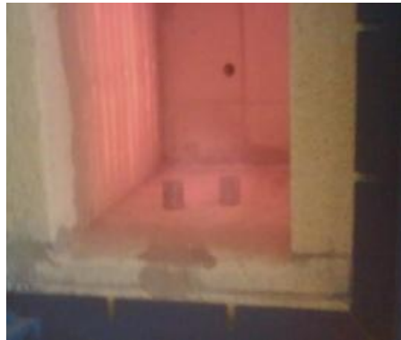
Gráfico Nº 99. Calentamiento del Acero AISI 1045 para el temple Fuente: lab. Metalografía UTA-FICM Realizado por: Carlos Calderón
