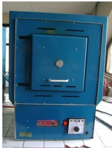
Gráfico N° 91. Sistema de Control Digital del Horno de Mufra. Elaborado por: Carlos Calderón
