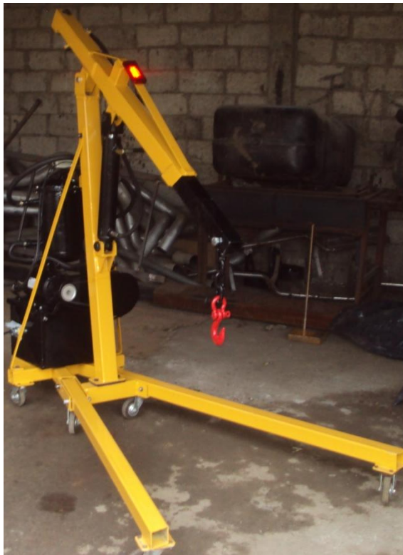
Figura N°6.61 Etapa final de construcción de la grúa (Fuente Autor)
