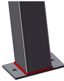
Figura N°6.25 Junta de soldadura en te del elemento columna (Fuente Autor)
