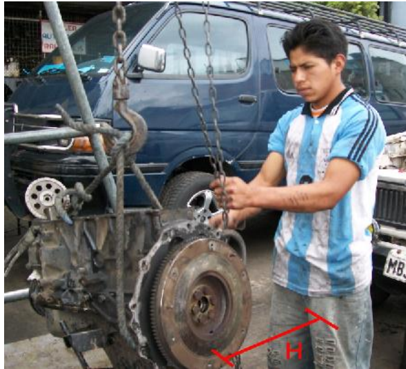
Figura N°4.4 Medición de la distancia horizontal en el destino del desmontaje (Fuente Autor)
