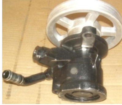
Figura N°6.63 Bomba Oleohidráulica (Fuente Autor)
