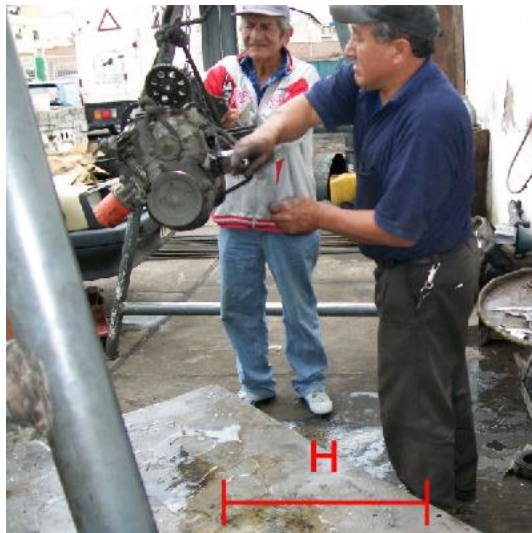
Figura N°4.3 Medición de la distancia horizontal en el origen del desmontaje (Fuente Autor)
