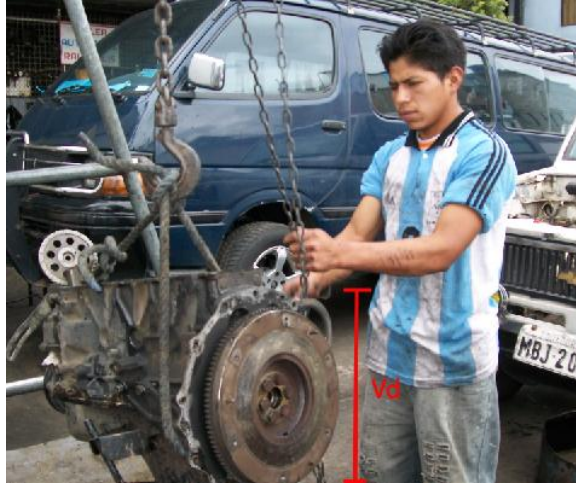
Figura N°4.2 Medición de la distancia vertical en el destino del desmontaje (Fuente Autor)
