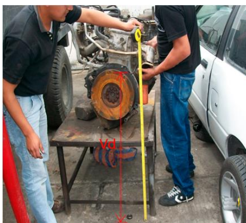
Figura N°4.6 Medición de la distancia vertical en el destino del montaje (Fuente Autor)
