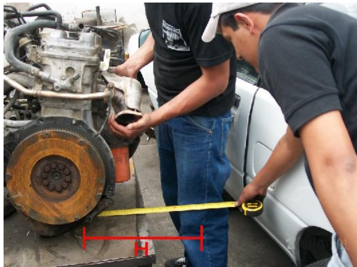
Figura N°4.8 Medición de la distancia horizontal en el destino del montaje (Fuente Autor)
