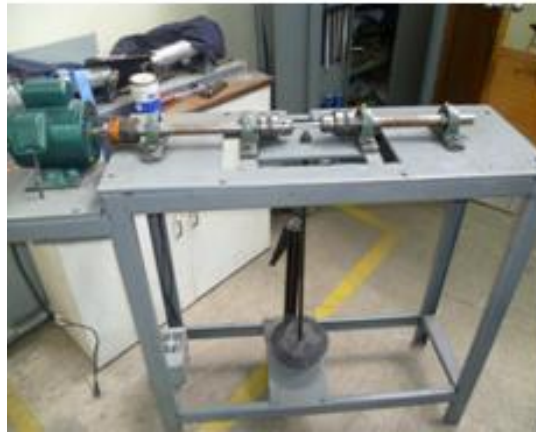
FIGURA No. 38 Máquina de Moore para Ensayo de Fatiga Fuente: JOSÉ CAIZA
