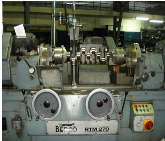
FIGURA No 24 Rectificadora de Cigüeñales BERCO 270
