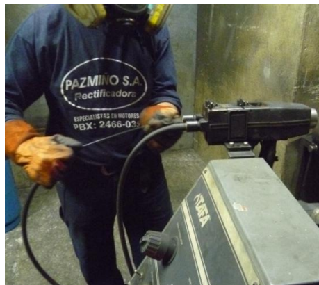
FIGURA No. 8 DISPARO DE MATERIAL CON LA MAQUINA METALIZACIÓN Tafa 8830 FUENTE: TALLERES RECTIFICADORA PAZMIÑO S.A
