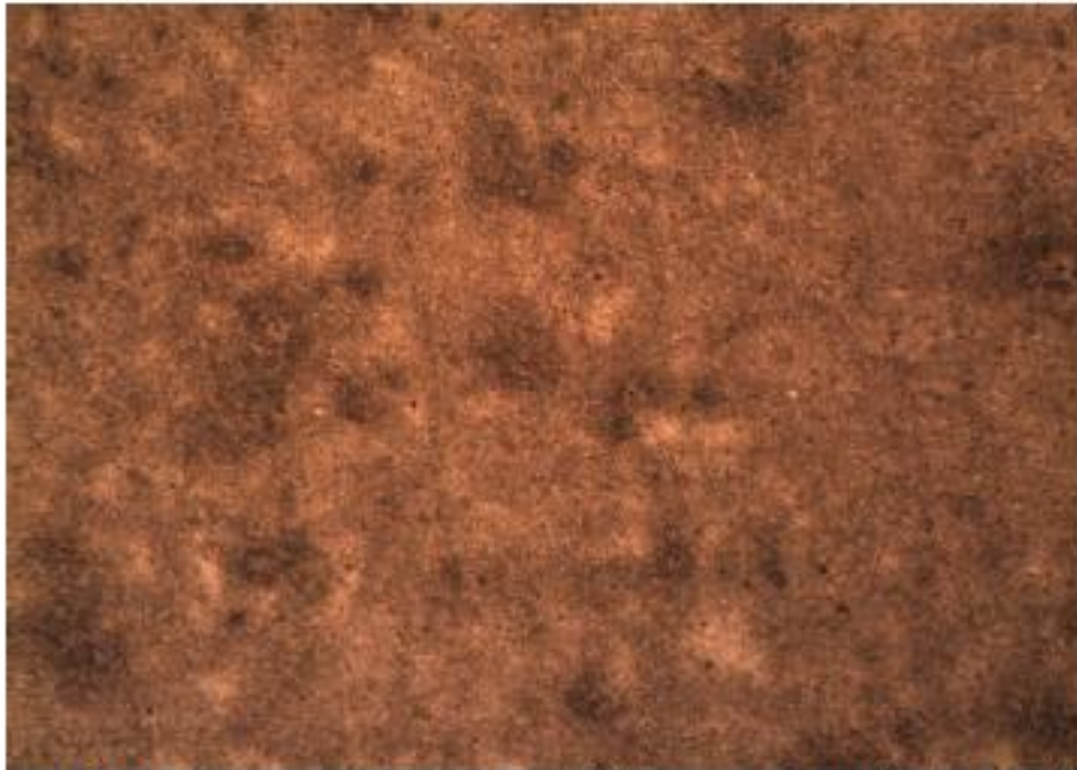
Fotografía N°8. Se observa una estructura de acero bainítico con gran cantidad de inclusiones del tipo silicato con tamaños no mayores a los 52 \mu\text{m} 100X.
