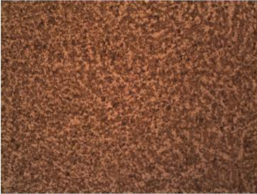
Fotografía N°4. Estructura del acero con matriz perlítica con contenido medio de carbono. Se observa la presencia de inclusiones del tipo silicato con tamaños no superiores a 50 \mu\text{m} . 100X.
