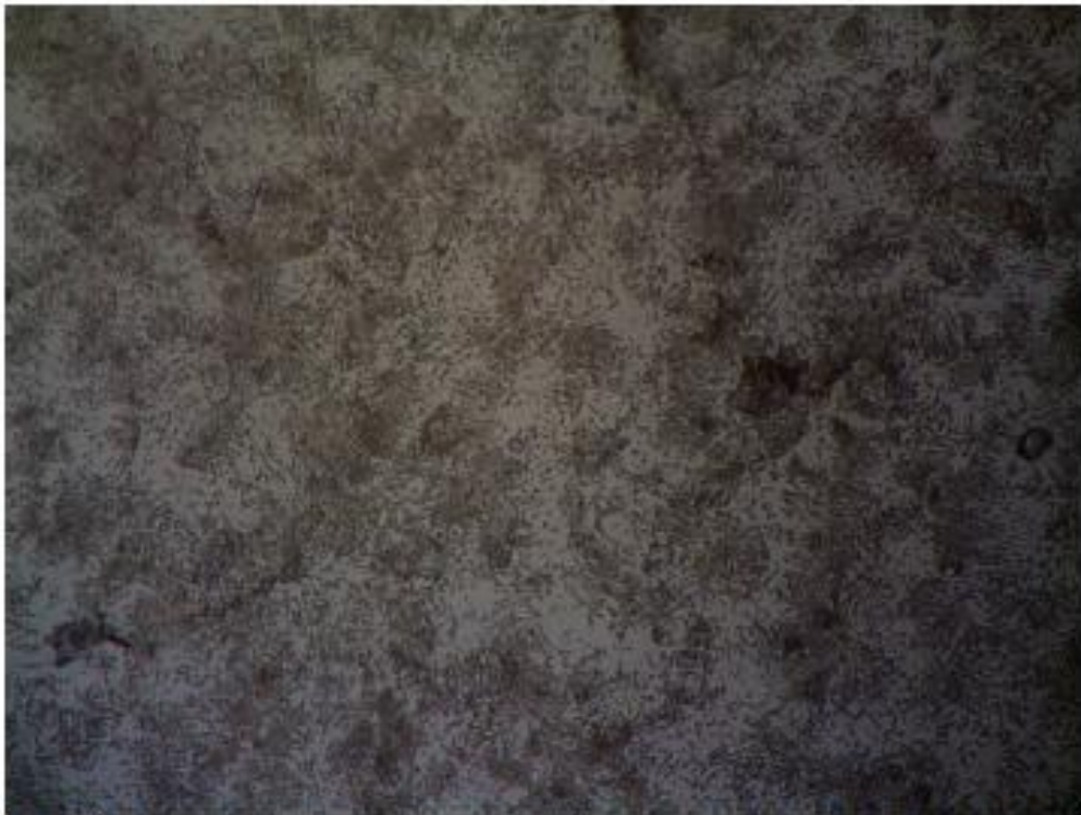
Fotografía NR3. Estructura del acero con matriz perlítica. Se observa que la perlita es gruesa y se descompone en glóbulos. 300X.
