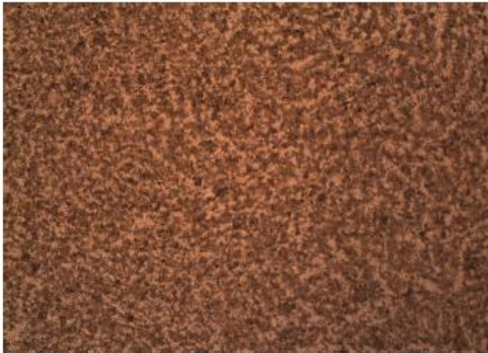
Fotografía N°4. Estructura del acero con matriz perlítica con contenido medio de carbono. Se observa la presencia de inclusiones del tipo silicato con tamaños no superiores a 50 \mu\text{m} . 100X.
