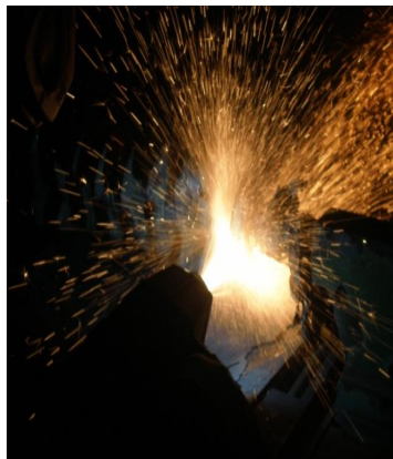
FIGURA No. 9 MOMENTO DEL DISPARO DE MATERIAL PARA METALIZAR FUENTE: TALLERES RECTIFICADORA PAZMIÑO S.A
