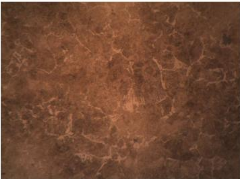
Fotografía N°7. Estructura del acero con matriz perlítica. Se observa que la ferrita ha precipitado en los bordes de grano. Se observa también la presencia de sulfuro de manganeso. 300X.
