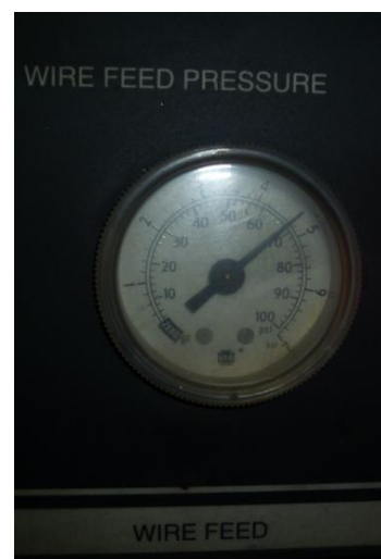
FIGURA No. 4 VERIFICAR PRESION DE LA MAQUINA METALIZADORA TAFE 8830 FUENTE: TALLERES RECTIFICADORA PAZMIÑO S.A
