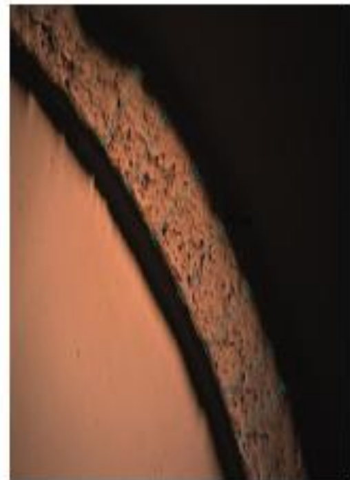
Fotografía N°13.- Muestra 4. Se puede observar que existe separación del metalizado con el material base. Espesor promedio metalizado 520 um. 100X.
