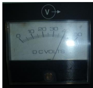
FIGURA No. 6 INDICADORES DE VOLTAJE DE LA MAQUINA METALIZADORA TAF A 8830 FUENTE: TALLERES RECTIFICADORA PAZMIÑO S.A
