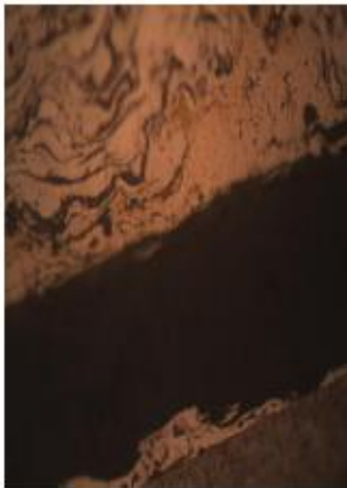
Fotografía N°12.- Muestras 4. Se observa que existe desprendimiento del metalizado y el material base, observándose separación entre los mismos 300X.
