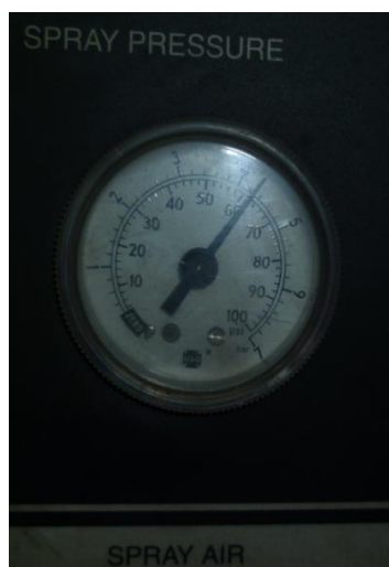
FIGURA No. 4 VERIFICAR PRESION DE LA MAQUINA METALIZADORA TAFE 8830 FUENTE: TALLERES RECTIFICADORA PAZMIÑO S.A
