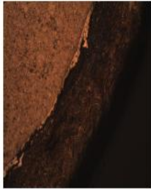
Fotografía N°11.- Muestra 2. Se puede observar que no existe adherencia entre el metalizado y el material base. Espesor promedio metalizado 435um. 100X.
