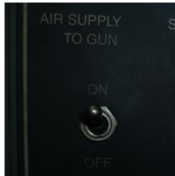
FIGURA No. 5 ENCENDIDO DE LA MAQUINA METALIZADORA TAF A 8830 FUENTE: TALLERES RECTIFICADORA PAZMIÑO S.A
