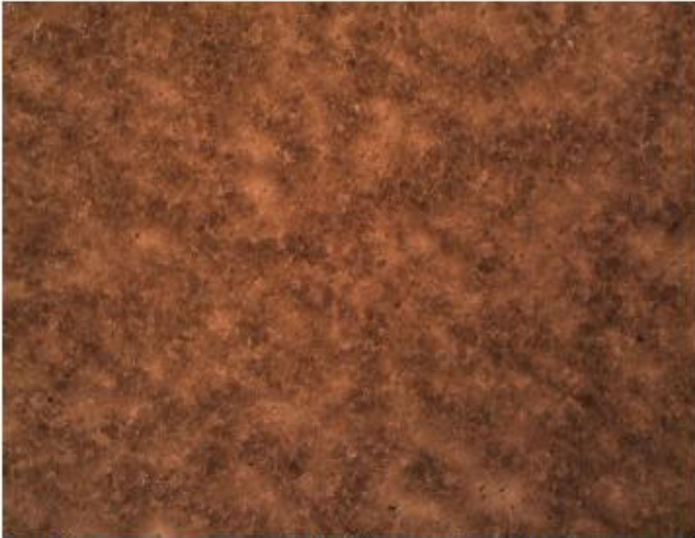
Fotografía N°6. Estructura del acero con matriz perlítica con contenido medio de carbono. Se observa la presencia de inclusiones del tipo silicato con tamaños no superiores a 46 \mu\text{m} . 100X.
