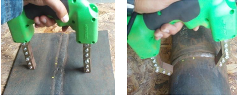
Gráfico N°6.22 Magnetización de la probeta.
