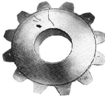
Gráfico N° 2. 16. Grietas de temple en un piñón. Indicaciones por partículas magnéticas.
