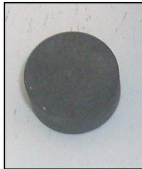
**Figura 32.** Probeta de Hierro Fundido Gris Recocida a 754°C durante 4h ( $\frac{3}{4}$  de diámetro y de 1cm de longitud)
