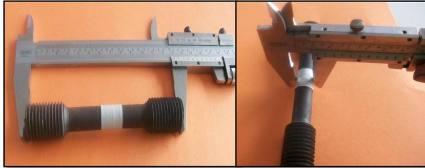
**Figura 31.** Probeta de Hierro Fundido Gris calibrada después de haber realizado el ensayo de tracción
