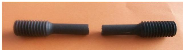
**Figura 30.** Probeta de Hierro Fundido Gris luego de haber realizado el ensayo de tracción
