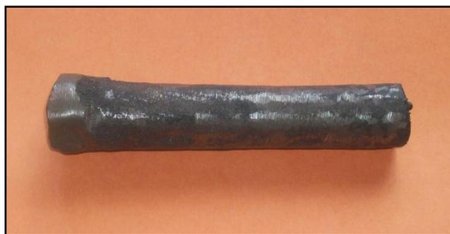
**Figura 25** Probeta de Hierro Fundido Gris de 5pulgadas
