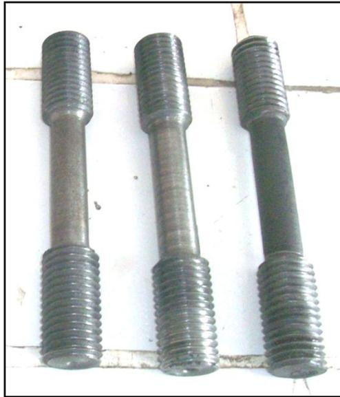
**Figura 26.** Probetas de Hierro Fundido Gris para ser Recocidas.
