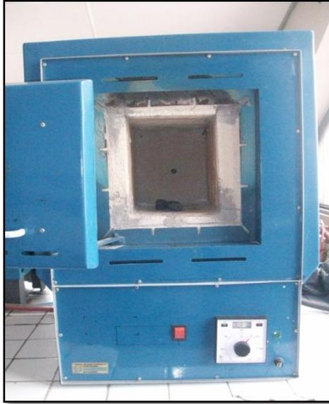
**Figura 27.** Horno para realizar el Recocido
