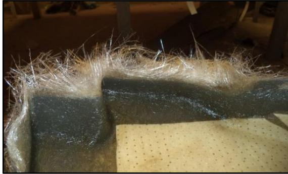
**Fig. 28:** Exceso material
