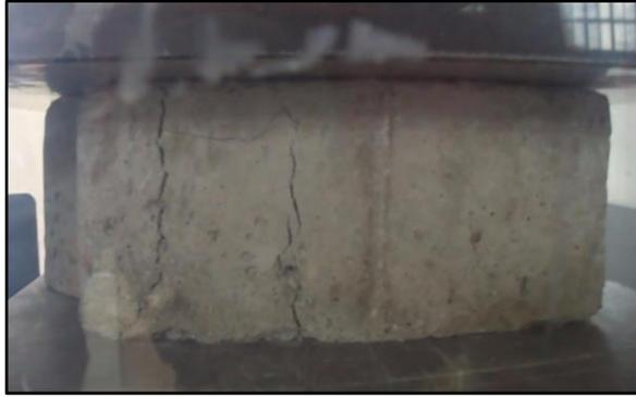
**Fig. 42:** Limite de fractura
