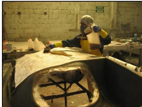
**Fig. 15:** Aplicación resina-fibra
