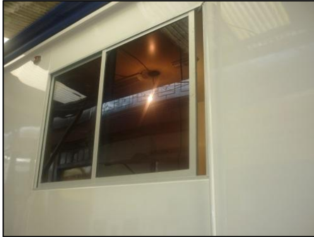
Fig. 13: Ventana instalada en paredes laterales de furgón
