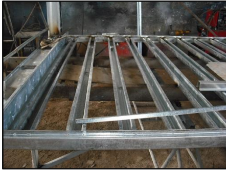
Fig. 17: Detalle de omegas producidas en dobladora
