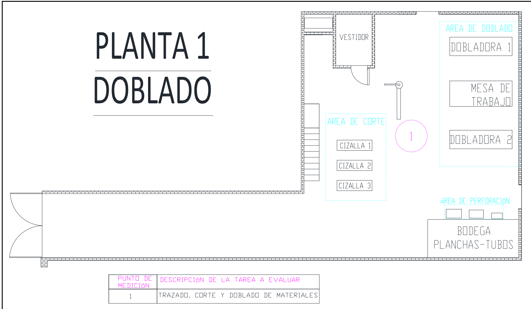
Fig. 35: Localización punto de medición en Planta 1
