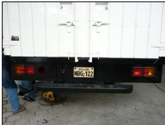
Fig. 26: Instalación de guardachoque posterior
