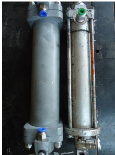
IMAGEN 6.7.- Instalación de racores en los cilindros. 52
