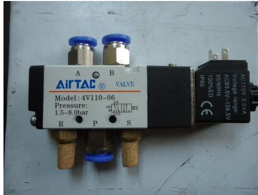
IMAGEN 6.6.- Instalación de los elementos en las electroválvulas. 51
