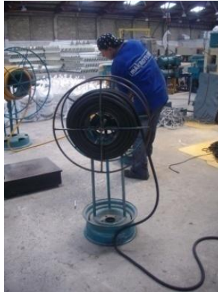
Figura 10: Proceso de Bobinado en la empresa Holviplas S.A.
