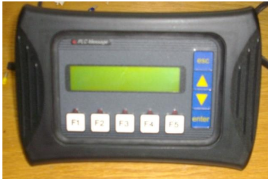
Figura 35: Pantalla EzText 220. Fuente, Manual EZ Text 220
