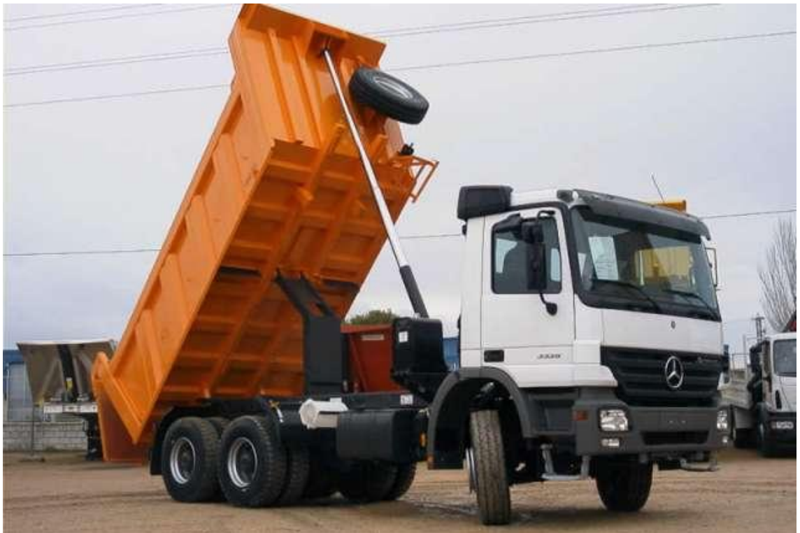
Sistema hidráulico en funcionamiento montado sobre una volqueta.
