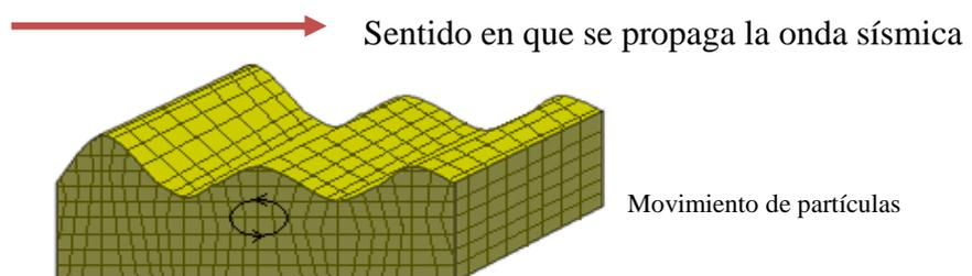
Ilustración 6. Esquema de Onda de Rayleigh
