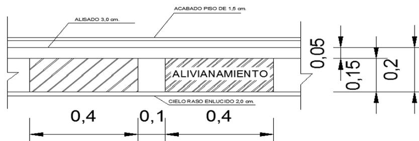
Ilustración 16. Corte de Losa
