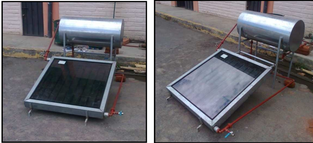
Figura 6.1 Colector solar plano de circulación natural para calentamiento de agua.
