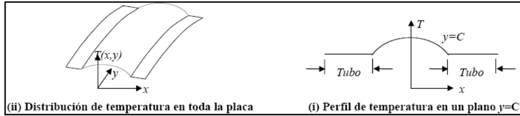
Figura 6.10 Distribución de la temperatura en la placa de absorción.
