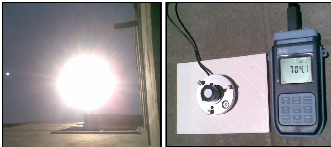
Figura 3.8 Medición de la Irradiancia con el Piranómetro en un medio día soleado.
