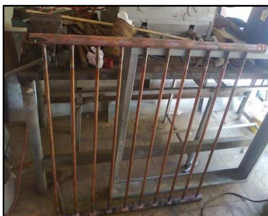
Figura 6.20 Fotografía del serpentín con los tubos soldados. Fuente: Autor.
