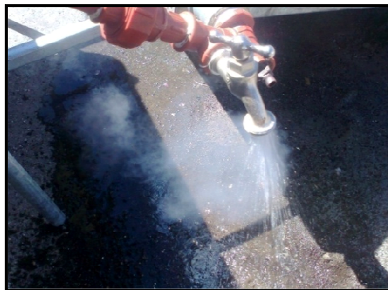
Figura 6.25 Salida del agua del panel a altas temperaturas al final del ensayo.
