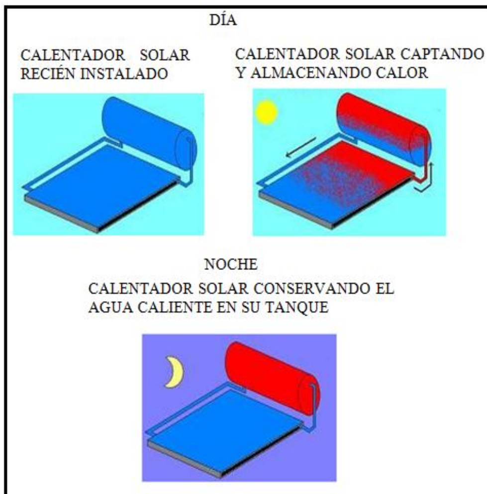
Figura 2-9 Funcionamiento de un Calentador Solar de Agua.
