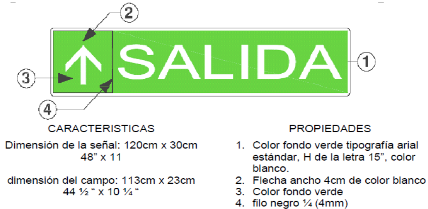
Fig. N° 13: Características para la señalización de salidas de emergencia
