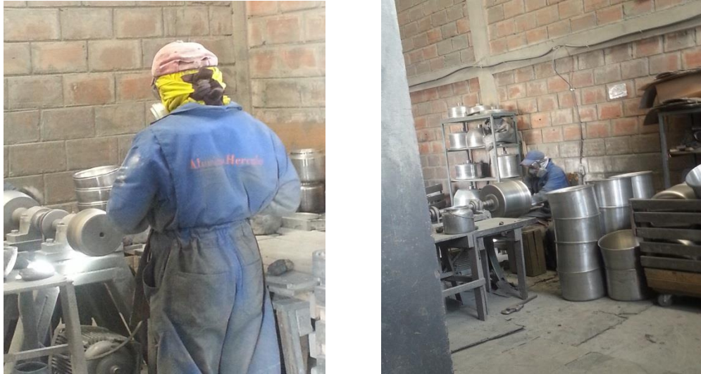
Fig. N° 6: Proceso de pulido
