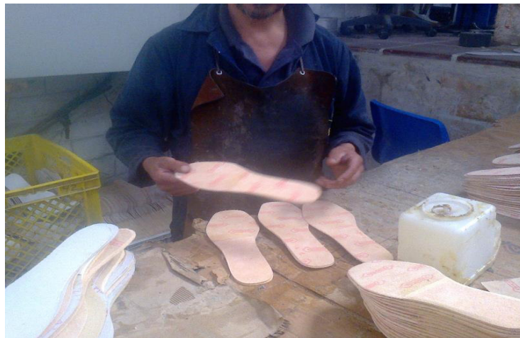
Figura 26. Pegado de recuñas y plantillas
