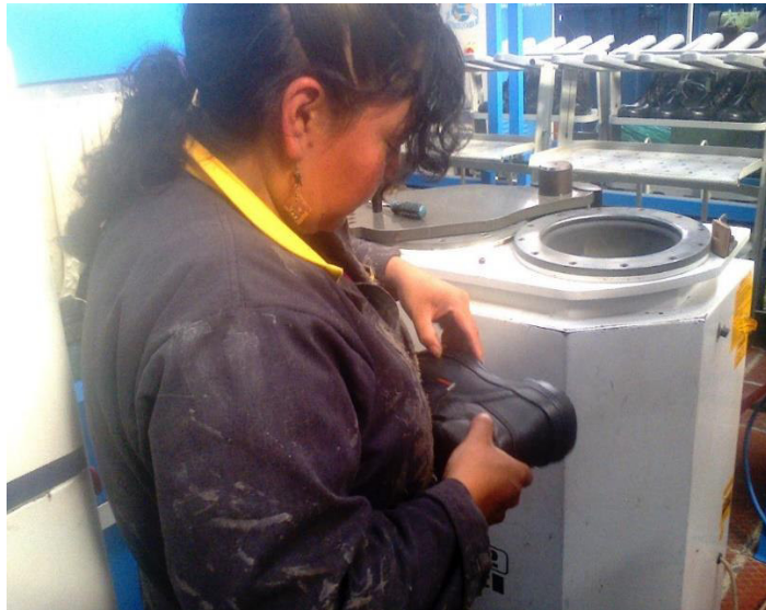
Figura 33. Reactivadora de pega
