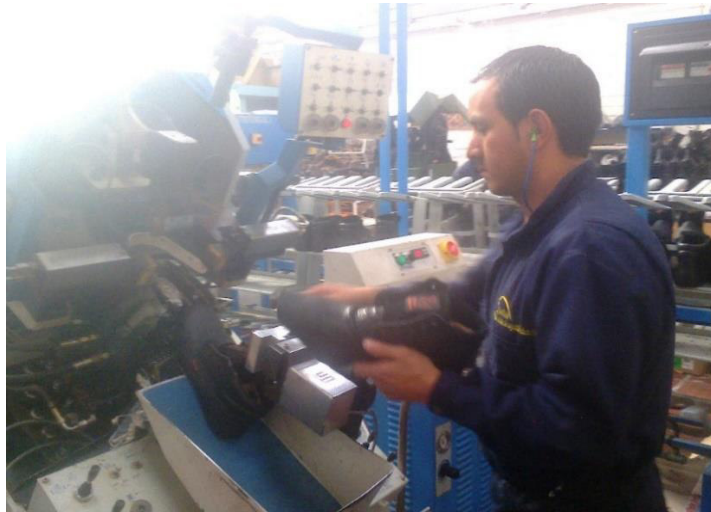
Figura 28. Armado de puntas
