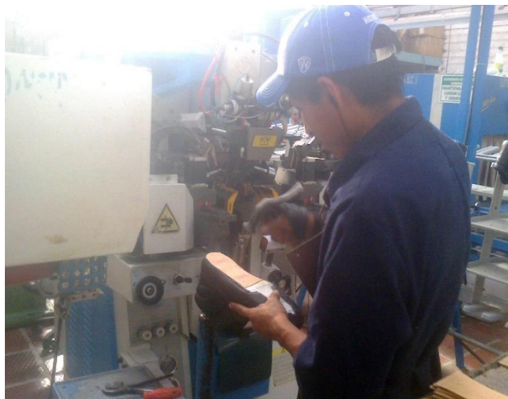
Figura 29. Armado de lados
