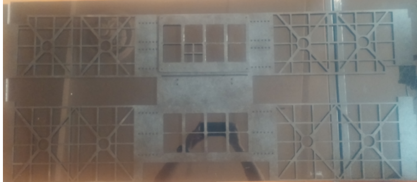
Figura 104: Estructura de MDF cortada en laser Fuente: Investigador
