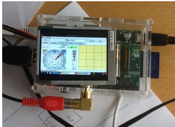
Figura 81: Controlador impresora con Pronterface en un Raspberry Pi
