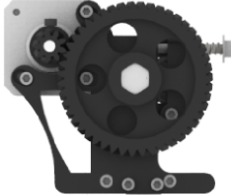
Figura 75: Diseño del reductor del extrusor Fuente: Investigador. Realizado en OpenSCAD
