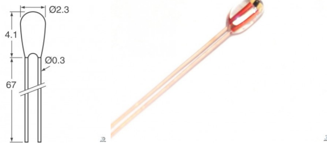
Figura 72: Termistor EPCOS B57560G1104F Fuente: Gadgets 3D
