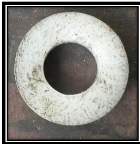
Figura 12.2: Sujetador de Nylon para la masa adicional del Dardo Elaborado por: El Investigador
