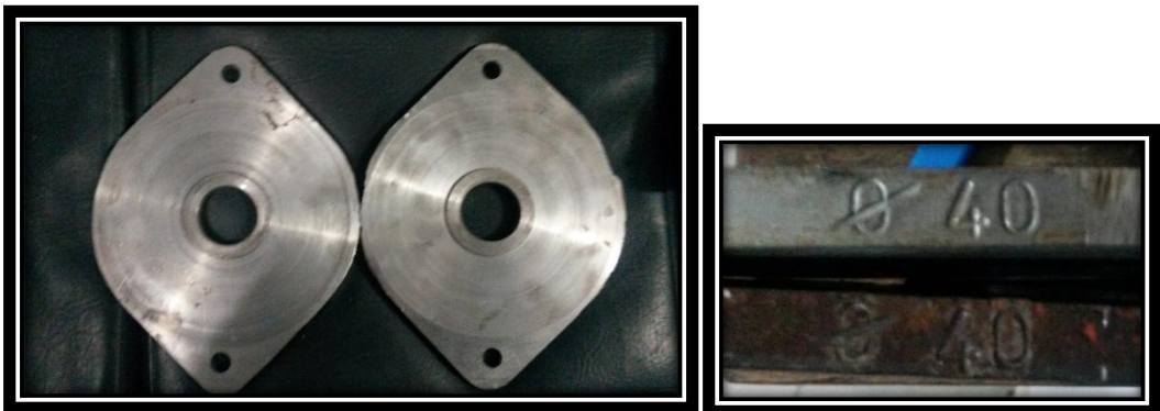
Figura 7.1: Mordazas para Geometría FB y FE Elaborado por: El Investigador
