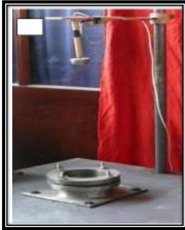
Figura 2. 13 .Maquina de Impacto por caída de dardo Fuente: (Paredes, 2012)
