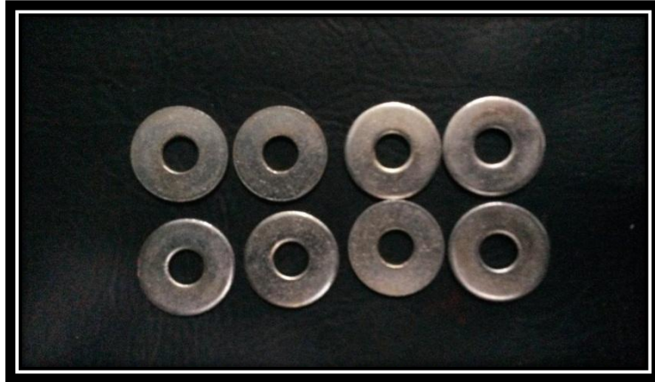
Figura 7.1: Rodela para añadir masa a los Dardos
