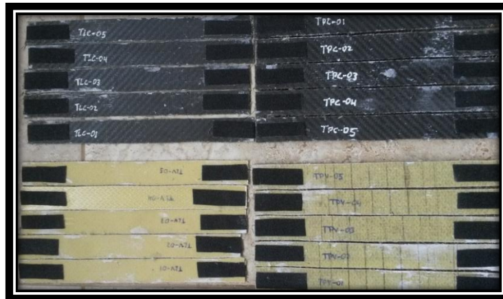
Probetas Referenciales para ensayos a Tracción (25x250xe) mm
