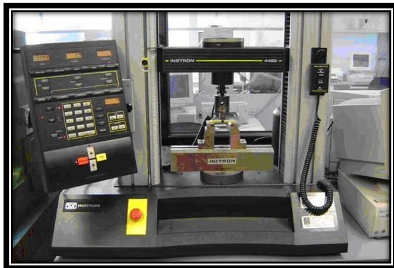
Figura 2. 12 .Ensayo de Flexión Fuente: (Mariano, 2011)
