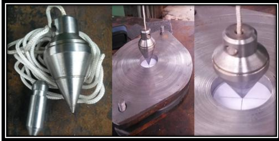
Figura 13.1: Montaje de Plinto en el centro de gravedad
