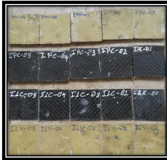
Probetas Referenciales de ensayos a Impacto (58x58xe) mm
