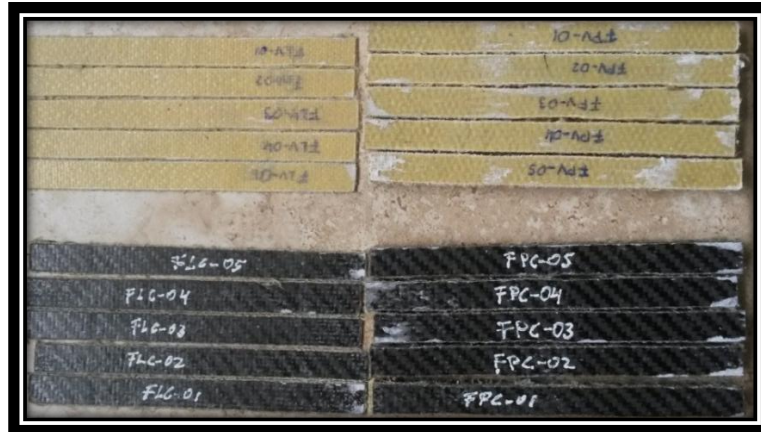
Probetas Referenciales para ensayos a Flexión (13x160xe) mm
