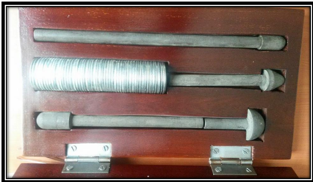
Figura 6. 1 Dardos y Masa adicional Elaborado por: El Investigador
