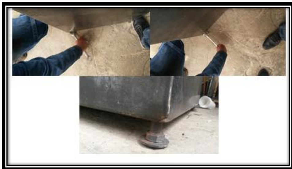
Figura 13.2: Ajuste de la mesa para nivelar la caída de Dardo Elaborado por: El Investigador
