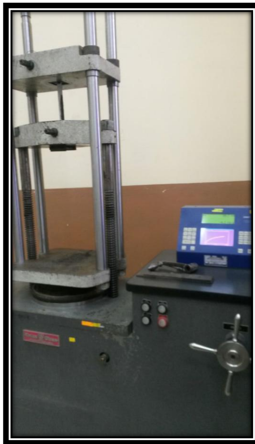
Figura 4. 4 Maquina Universal de ensayos Serie L Tinius Olsen tipo A Elaborado por: El Investigador
