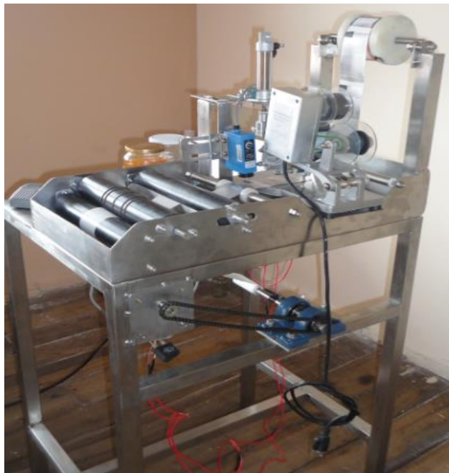
Figura 6.35: Máquina etiquetadora semiautomática construida con fechador
