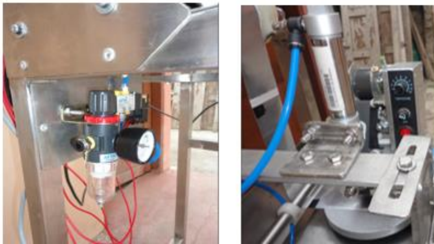
Figura 6.28: Sistema neumático del fechador
