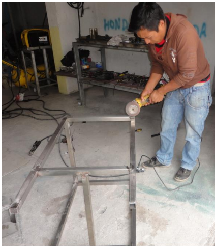
Figura 6.31: Proceso de desbaste
