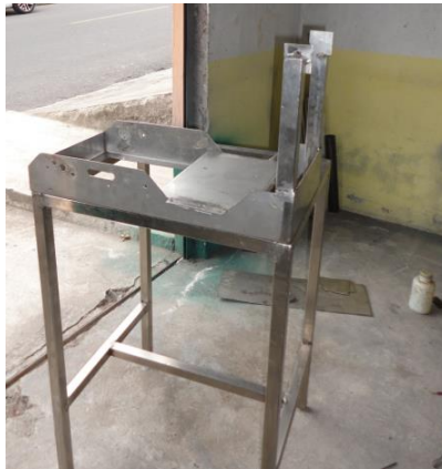
Figura 6.32: Ensamblaje de base y la estructura
