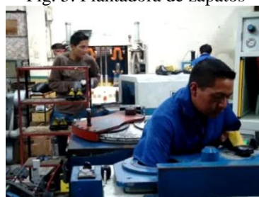
Fig. 5: Plantadora de zapatos
