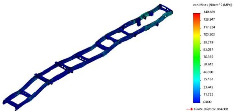
**Figura 4.14** Tensiones de Von Mises chasis con perfil en U
