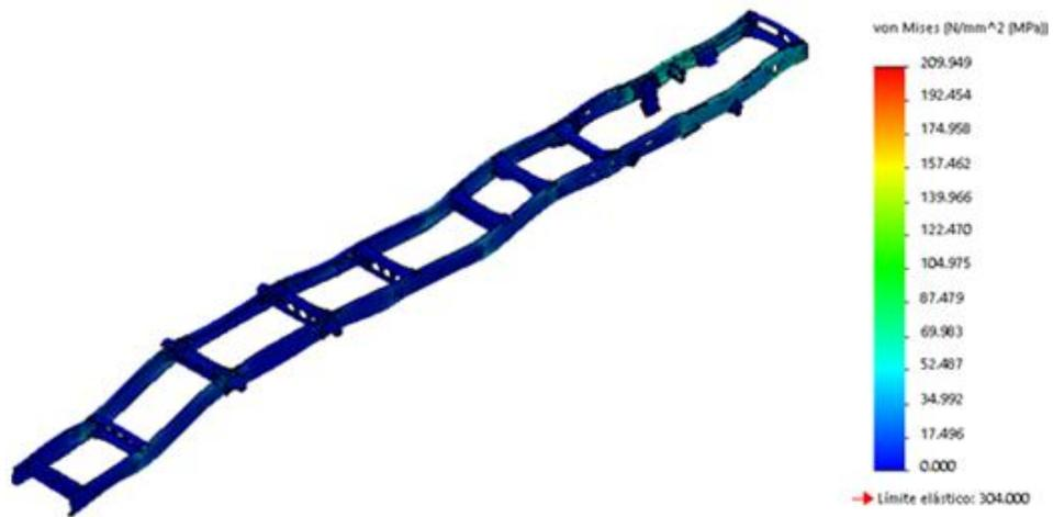
**Figura 4.28** Tensiones de Von Mises chasis con suelda
