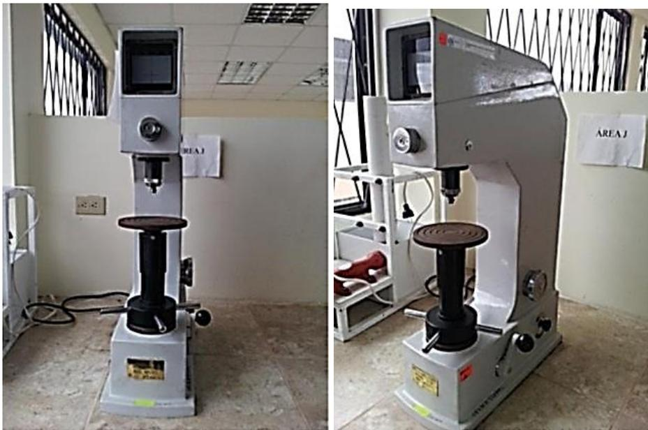
**Figura 2.18** Durómetro para escalas Brinell, Rockwell y Vickers.
