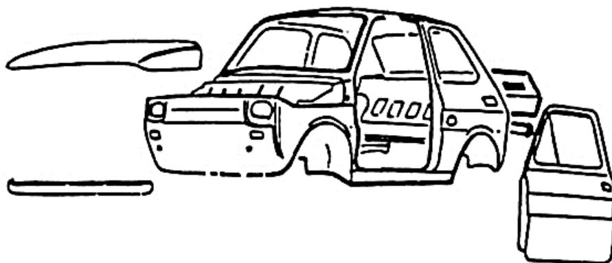
**Figura 2.6** Carrocería con chasis plataforma
