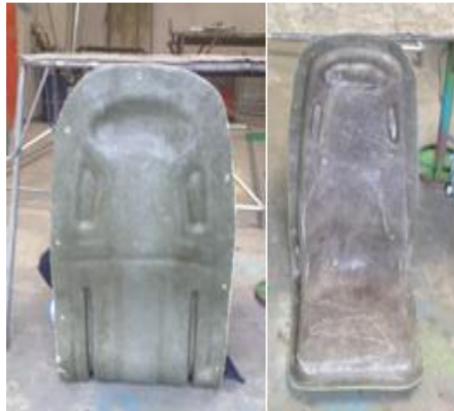
Figura 6-15 Molde tapa 2 del asiento de un bus urbano
