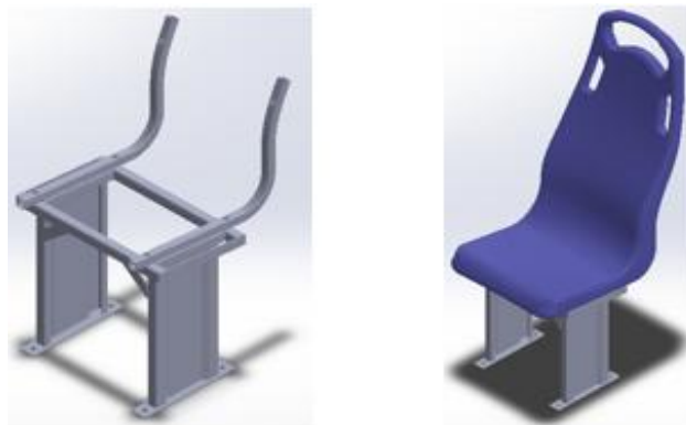
Figura 6-2 Estructura base del asiento de un bus urbano
