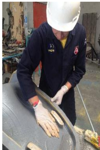
Figura 6-18 Molde untado con desmoldante
