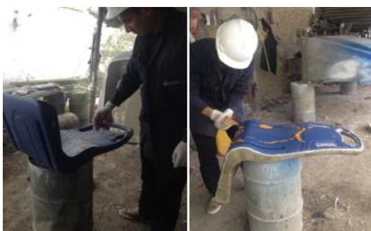
Figura 6-4 Aplicación de la cera
