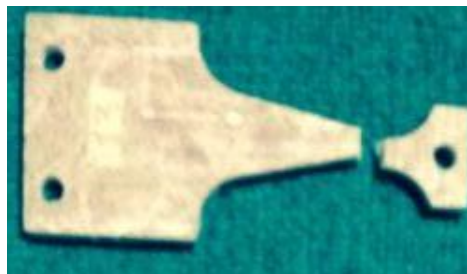
Figura 5-2 Forma de la ruptura de la probeta
