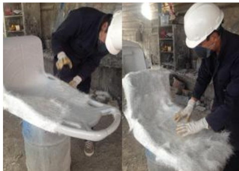
Figura 6-9 Colocación capa de fibra de vidrio parte frontal
