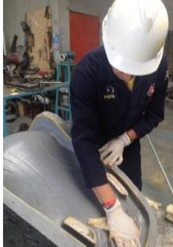
Figura 6-17 Molde removido con cera
