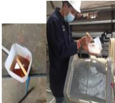
Figura 6-19 Molde aplicado resina poliéster
