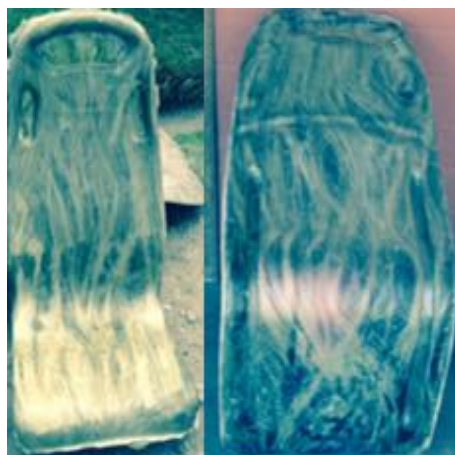
Figura 6-22 Asiento desmoldado vista de frente y el espaldar
