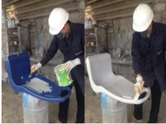
Figura 6-7 Aplicación del yercol en la superficie frontal
