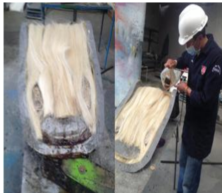
Figura 6-20 Ubicación de la fibra de cabuya en el molde
