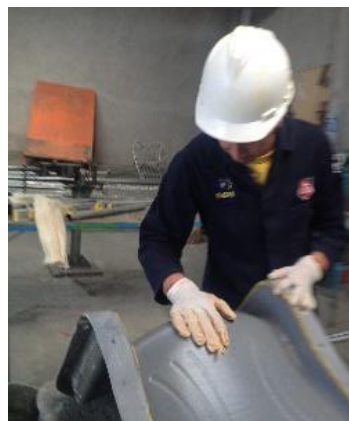
Figura 6-16 Molde untado con cera
