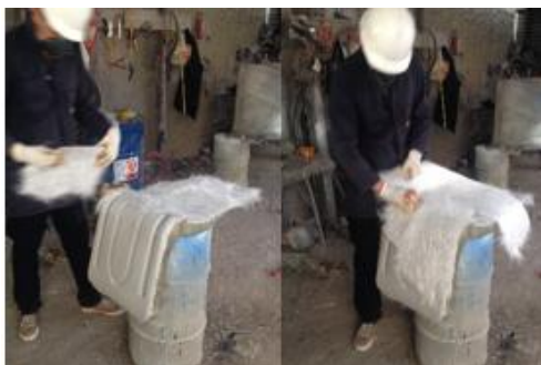
Figura 6-10 Colocación capa de fibra de vidrio parte posterior
