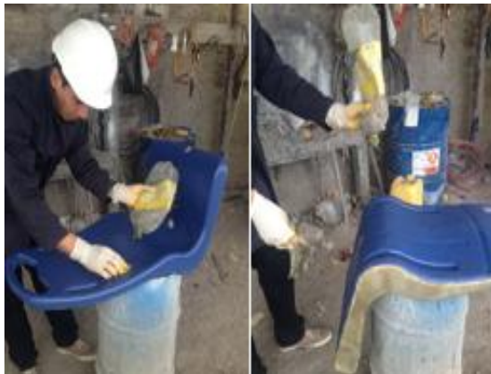
Figura 6-6 Aplicación del desmoldante
