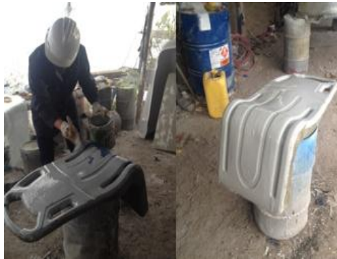
Figura 6-8 Aplicación del yercol en la superficie posterior
